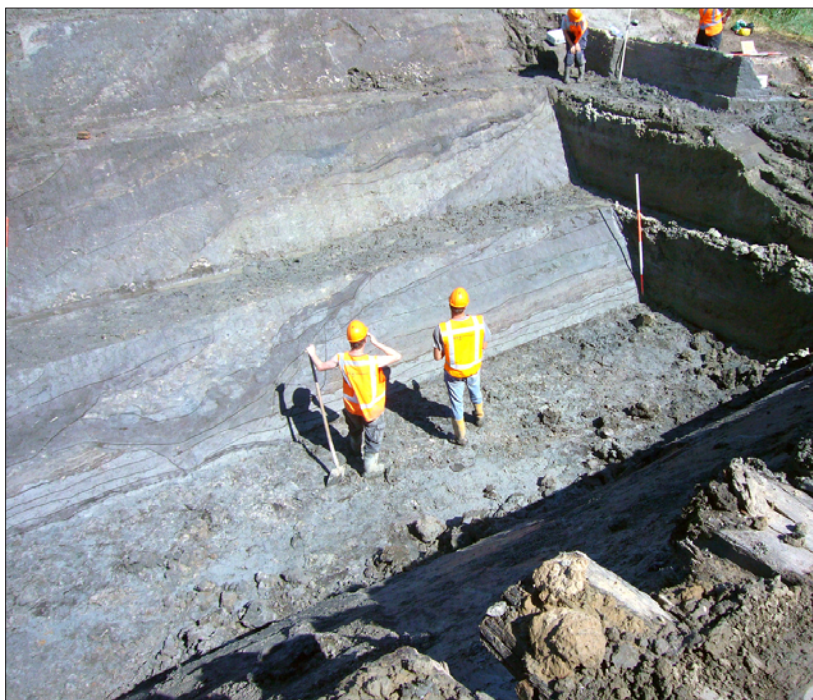
Afbeelding 5.3.38 Foto van het sleuvenonderzoek van het ADC. Let op de hoogte en de ligging van de funderingen (aan de rechterbovenzijde) ten opzichte van de dijkophogingen. foto: ADC
